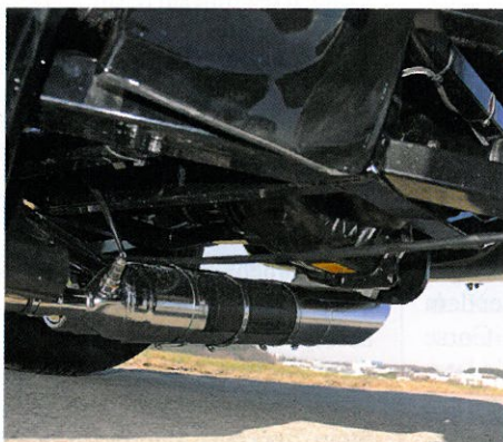
Wie aus einem Guss: Optisch passt der CT 800-Umbau sauber zum unveränderten Intruder-Vorderteil. Das Gepäckfach fasst 75 Liter (oben links). Solide geschweißt: Das Rahmenheck in Starrachs-Bauweise wird vom Suzuki-Schwingenlager aufgenommen. Das Differenzial-Getriebe stammt aus dem Autobau (oben rechts).
